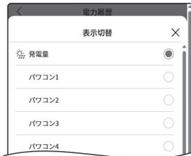
表示したい項目を選択して「決定」を選びます。選択した項目のデータを表示します。分岐ブレーカごとの消費を表す「個別消費量」の名称設定は「個別電力計測設定」で行います。（41 ページ）
