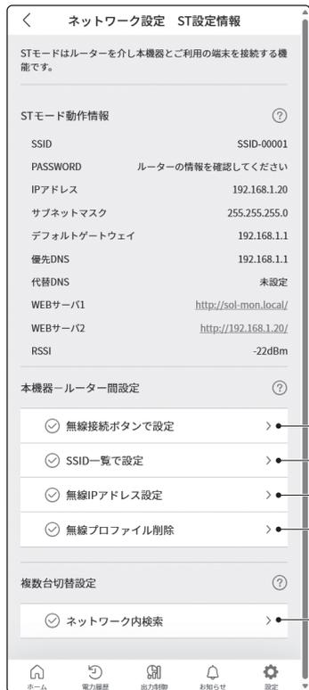
無線接続ボタンを使って、電力計測制御ユニットとルーターの無線接続を行います。(※ 1)
