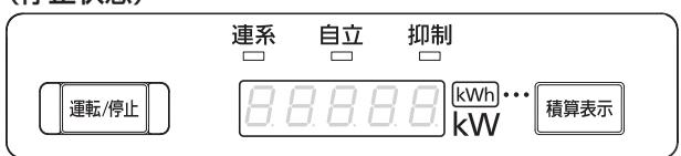
表示が消え、連系ランプが消灯し、パワーコンディショナは運転を停止します。
