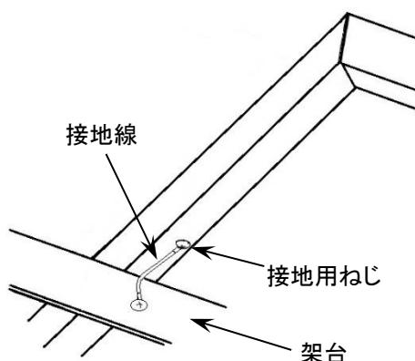
図 4 架台への接地工事
