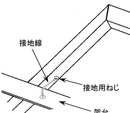
図 4 架台への接地工事
