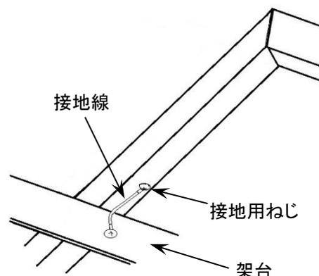
図 4 架台への接地工事
