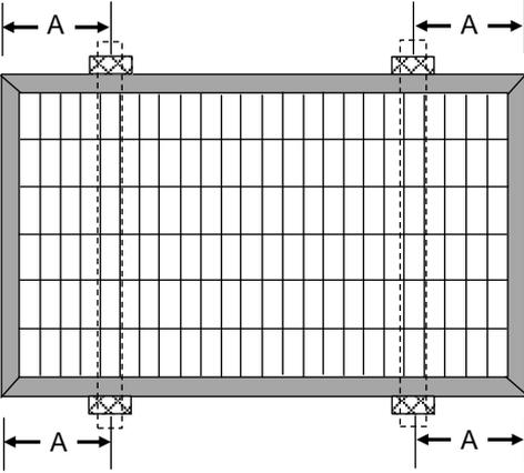
棧をモジュール長辺に対し垂直に配置し押さえ金具にて4箇所固定する
