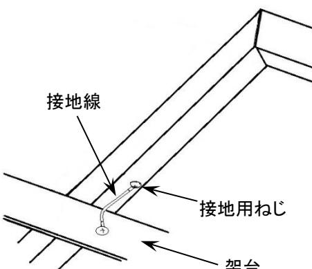
図 4 架台への接地工事
