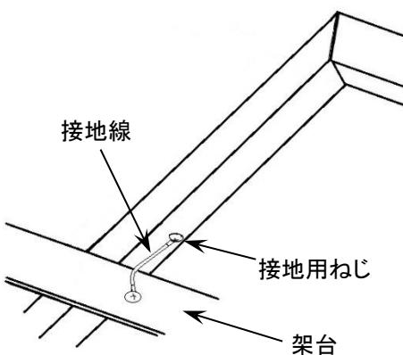
図 4 架台への接地工事
