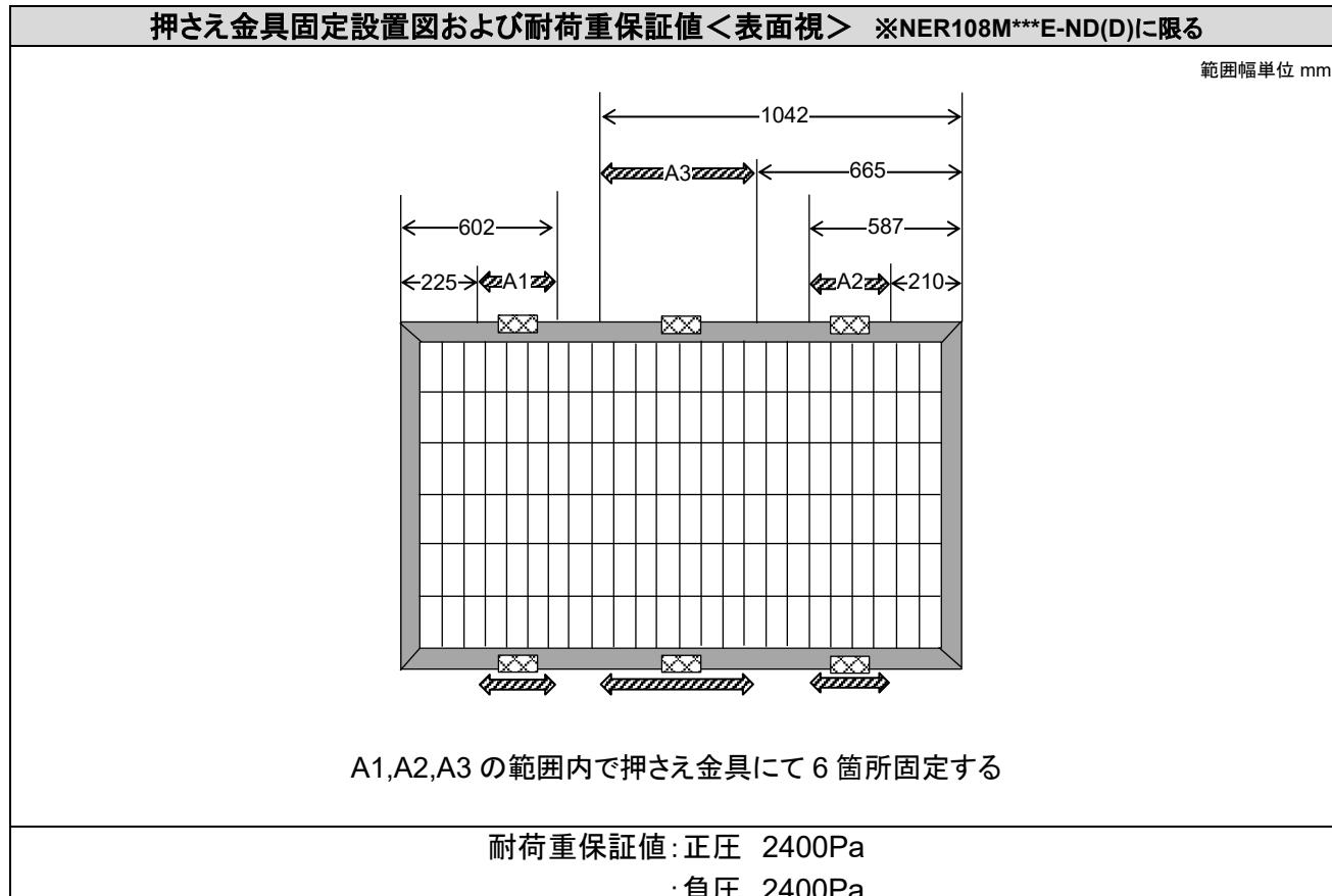
**正圧荷重**…太陽電池モジュールの表面に掛かる静的最大負荷(風圧と積雪)。
