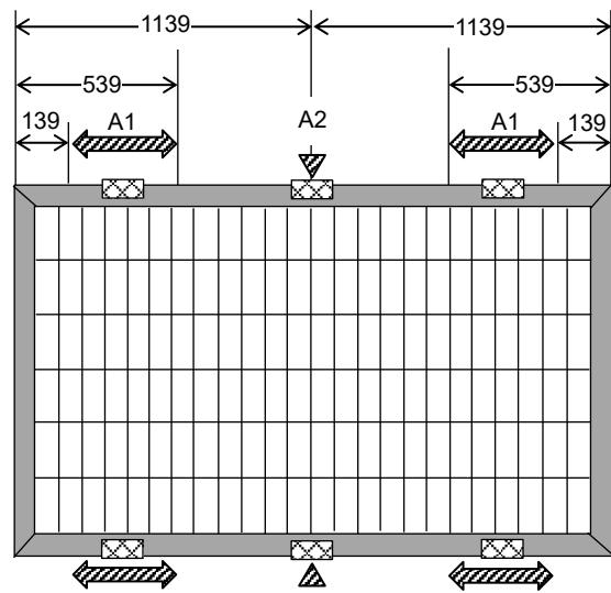
A1 の範囲内で 4箇所固定およびモジュール中心点 A2 に 2箇所固定の計 6箇所を押さえ金具にて固定する
