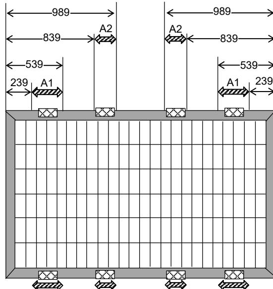
A1 の範囲内で 4箇所固定および A2 の範囲内に 4箇所固定の計 8箇所を押さえ金具にて固定する
