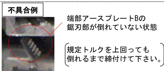
モジュール1枚につき山側ベースレール1に端部アースプレートBを1枚設置
