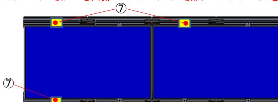
起点側のモジュール1枚のみ谷側ベースレール1に端部アースプレートBを1枚設置
