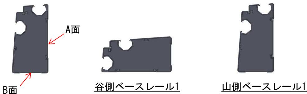
※耐震クラスBで屋根防水仕様が塩ビシート防水及びゴムシート防水以外の場合と、耐震クラスAで屋根防水仕様が塩ビシート防水及びゴムシート防水の場合に、谷側のA面に2枚、山側のB面に1枚滑り止めゴムシートを貼り付けし、地震時の架台の位置ズレを防止します。
