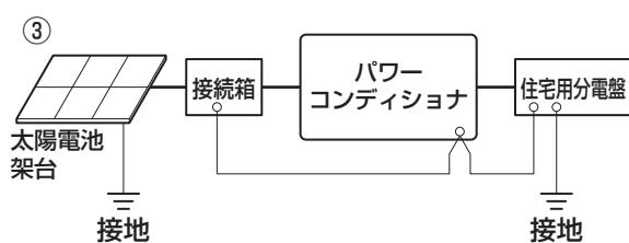
パワーコンディショナの接地端子は 1 つです。接地線の共締めは、右図 のように行ってください。
