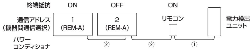
一括制御リモコン使用時は、必ず上図のよう（電力検出ユニットをリモコンにつなぐ）に接続してください。接続順や通信アドレス設定を間違えると正常に動作しない場合があります。
