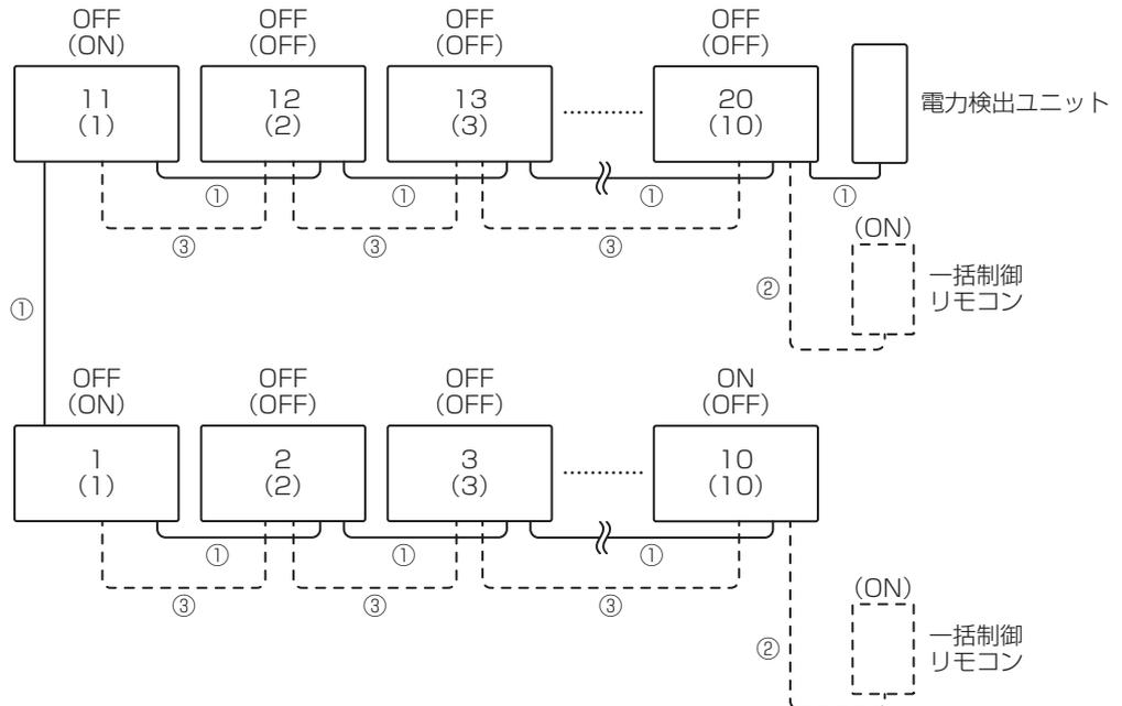
MODBUS コネクタが 2 か所あるパワーコンディショナがありますが、どちらを使用してもかまいません。太陽光パワーコンディショナの MODBUS スイッチを ON にしてください。また、MODBUS 終端抵抗、MODBUS アドレスを設定してください。一括制御リモコン (SPUR-1MA-NX) を接続する場合は、太陽光パワーコンディショナの独自通信 RS-485(H) の終端抵抗、アドレスも設定してください。
