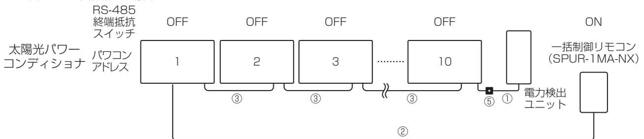
RS-485(H) コネクタが2か所あるパワーコンディショナがありますが、どちらを使用しても構いません。太陽光パワーコンディショナの通信切替スイッチをRS485にしてください。また、独自通信RS-485(H)の終端抵抗、アドレスを設定してください。
