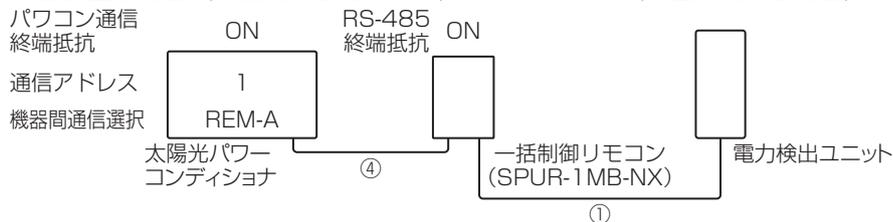
● 2 台～ 20 台設置の場合 (一括制御リモコン (SPUR-1MB-NX) と接続する場合)
