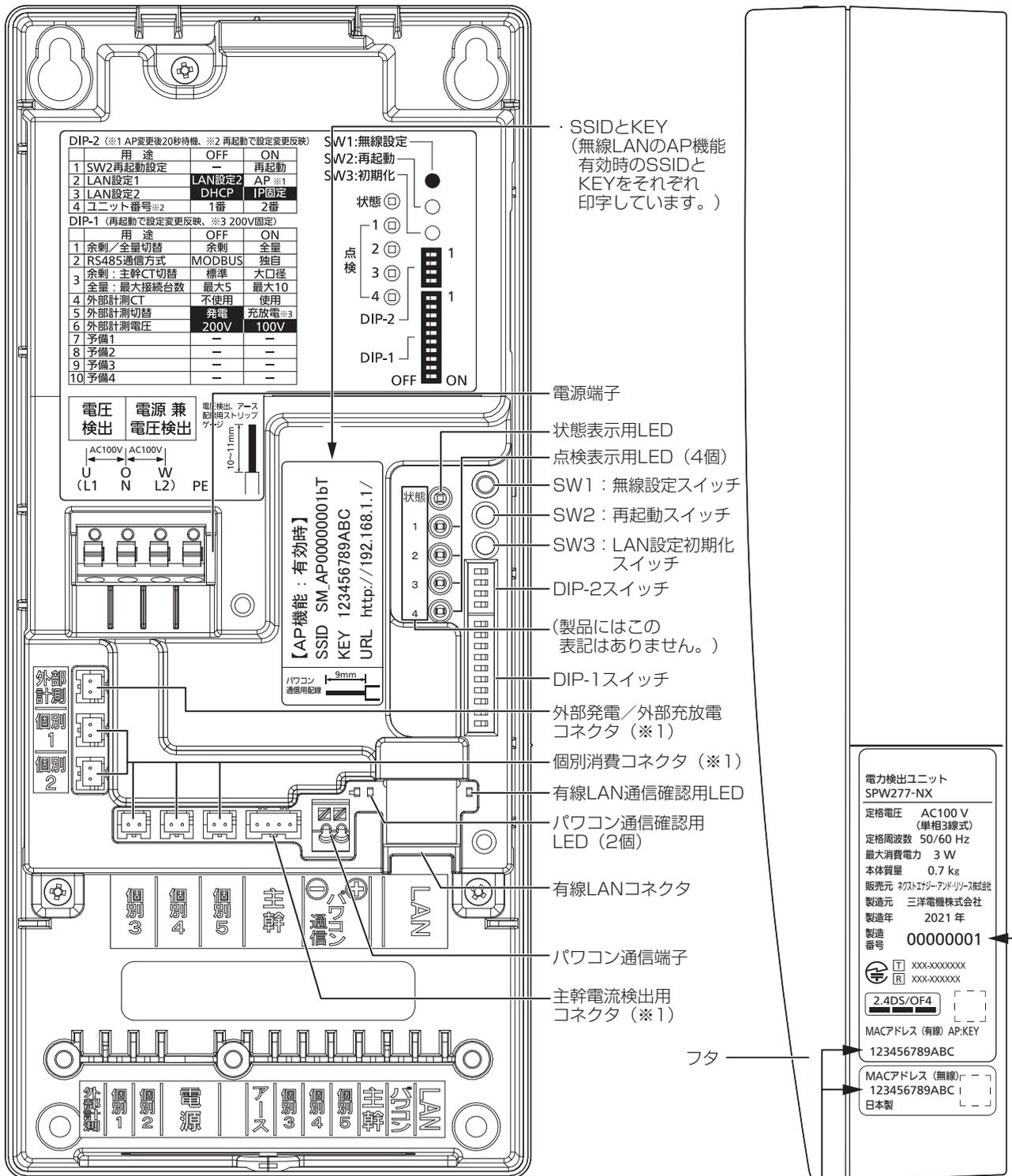
(フタを取り外し、配線固定金具を取り付けていない状態です。)
