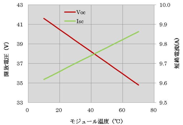
温度と開放電圧、短絡電流の関係 (300W)
